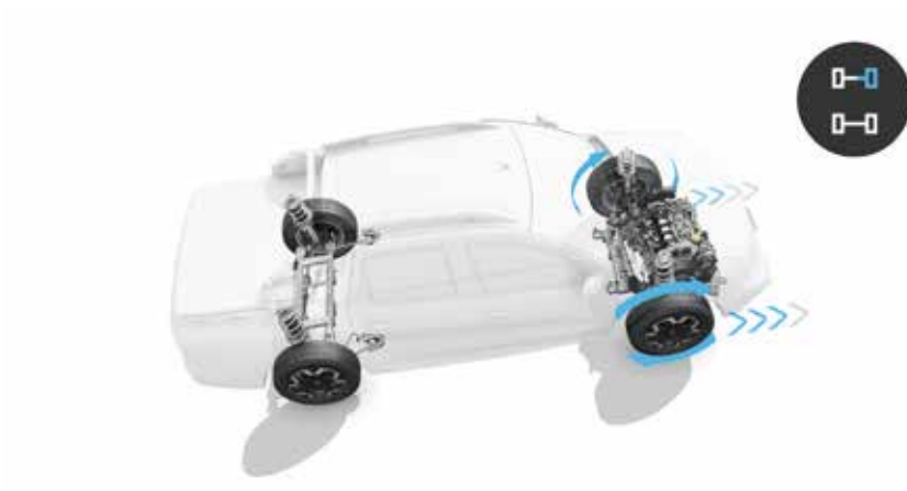
sistema de control de tracción (TCS) Limita el deslizamiento de las ruedas durante el arranque, aceleración y frenado.
