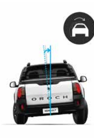
mitigación de vuelcos (ROM) Aumenta la estabilidad del vehículo cuando el riesgo de vuelco es alto.
