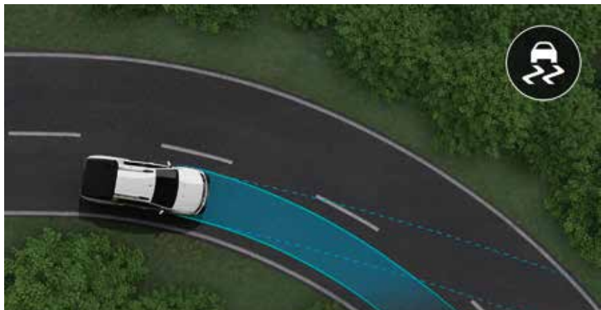
control de estabilidad electrónica (ESP) Corrige automáticamente la trayectoria de tu vehículo para que evites deslizamientos peligrosos.
