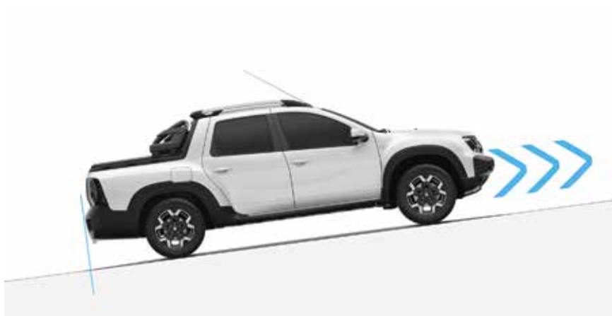
asistente de arranque en pendiente (HSA) Mantiene la presión de los frenos durante algunos segundos, evitando que el vehículo retroceda cuando te alejas en una pendiente pronunciada.
